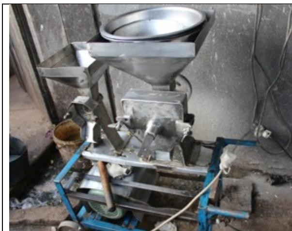
Exemple d'un broyeur multi fonction de manioc. Marché principale a Oyem.
